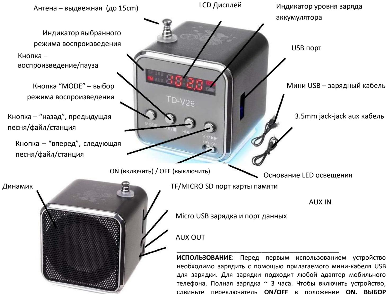
**ИСПОЛЬЗОВАНИЕ:** Перед первым использованием устройство необходимо зарядить с помощью прилагаемого мини-кабеля USB для зарядки. Для зарядки подходит любой адаптер мобильного телефона. Полная зарядка ~ 3 часа. Чтобы включить устройство, сдвиньте переключатель **ON/OFF** в положение **ON**. **ВЫБОР**
